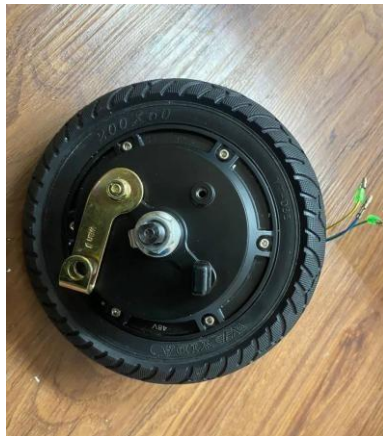
Imagen 7. Rueda del prototipo con el motor incluido
