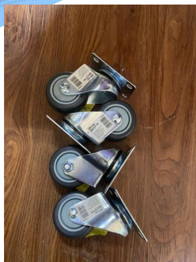
Imagen 10. Ruedas giratorias del prototipo
