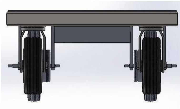
Imagen 4. Diseño de la base con las ruedas del prototipo (vista 2)
