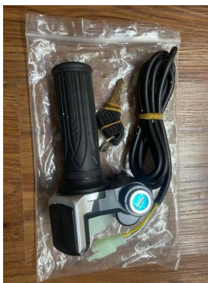
Imagen 11. Controlador de velocidad
