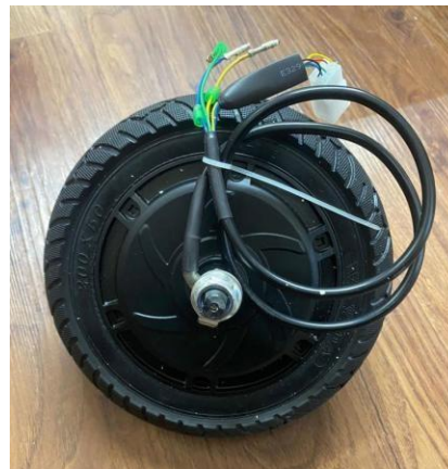
Imagen 7. Rueda del prototipo con el motor incluido
