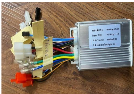
Imagen 8. Driver de los motores
